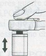
Toutes les clés à cliquets METRINCH sont équipées d'un mécanisme de retenue rapide qui permet de monter douilles et accessoires sans effort et sans risque, lesquels se libèrent aussitôt de la clef par simple pression sur le bouton.
