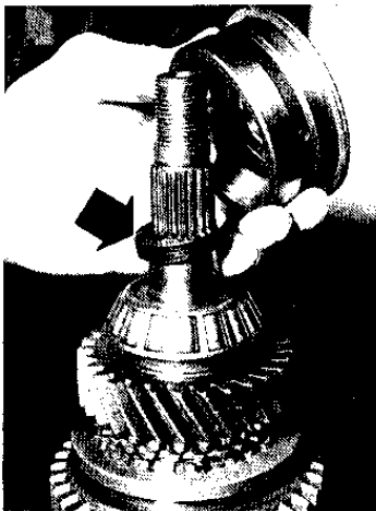
Dépose du roulement biconique et de la rondelle de réglage de la distance conique (Photo RTA)
