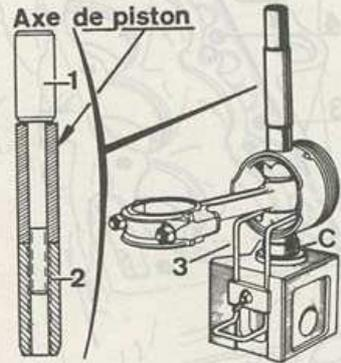
Mise en place de l'axe de piston à l'aide du mandrin de montage
